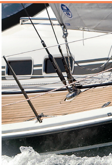
Det kan være lettest at tage de sidste omgange på vantskruerne i læ på kryds for derefter at vende og give præcis lige mange omgange i den nye læside, så masten stadig står helt lige.
