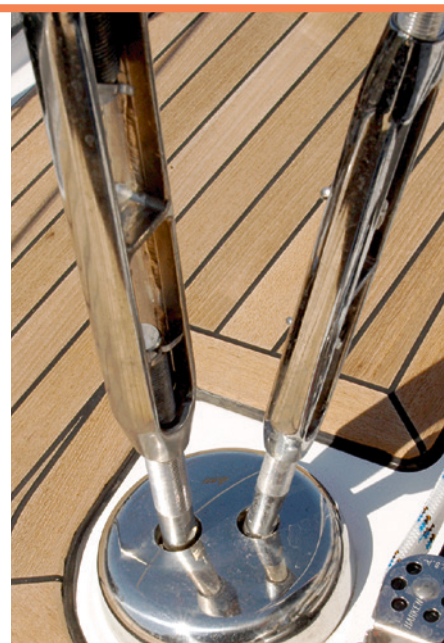
På moderne både har røstjernet næsten altid direkte forbindelse ned til bådens bundramme eller innerliner med enten en stålrod eller en glasfiberbjælke, så du roligt kan spænde riggen hårdt.
